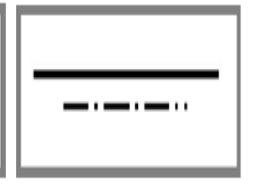
Şekil 2.9: Soğutulmuş ve ısıtılmış boru
